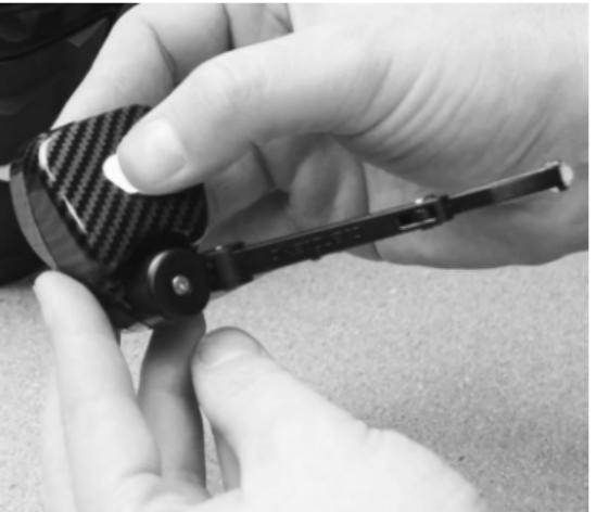
Um das Gerät EINzuschalten, drücken Sie die Taste an der HAUPT-EINHEIT und halten Sie diese ca. 3 Sekunden lang gedrückt, bis die WEISSE LED aufleuchtet.
